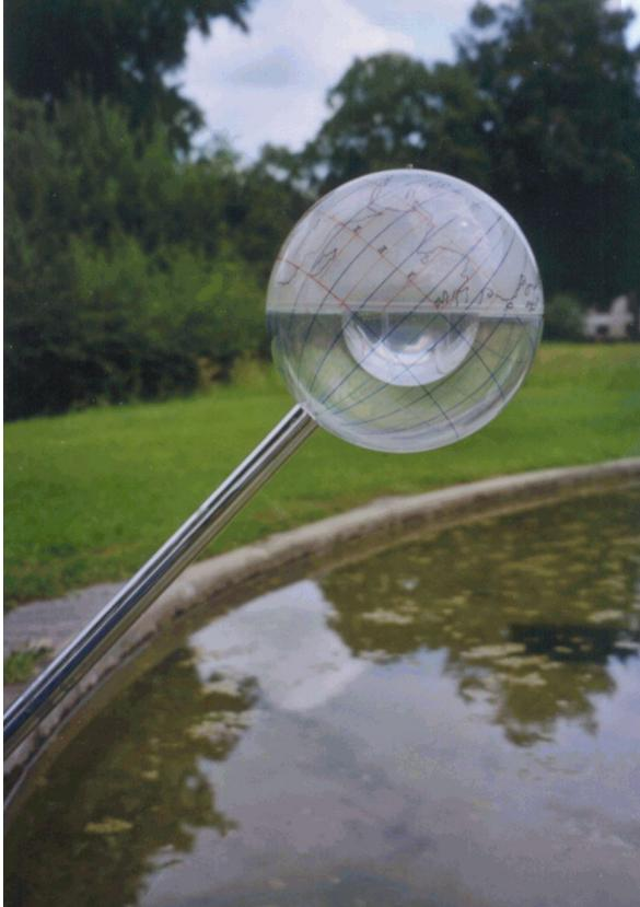
Abb.4 Reflex-Globus-Sonnenuhr ( $\varnothing$  16cm) am Rande eines Teiches ( $\phi=47^\circ$ ,  $\lambda=7,5^\circ$ )
